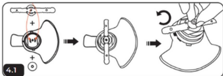
**4.1.** Quando a lâmina de plástico é instalada, os furos semicirculares em ambos os lados do meio da lâmina são direcionados para o fundo. Coloque a arruela e aperte a porca com chave (sentido horário ou anti-horário dependendo do modelo). (Atenção: lâminas de plástico são frágeis, sugerimos apenas para aparar grama levemente.)
