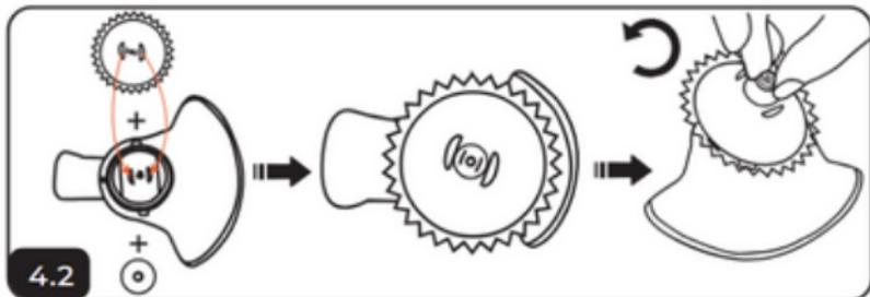
**4.2.** Quando a lâmina de serra é instalada, os orifícios semicirculares em ambos os lados da o meio da lâmina está voltado para baixo. Coloque a arruela e aperte a porca com chave (sentido horário ou anti-horário dependendo dos modelos)
