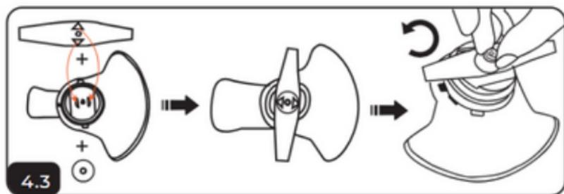
**4.3.** Quando a lâmina de metal é instalada, os furos semicirculares em ambos os lados de o meio da lâmina está apontado para o fundo. Coloque a arruela e aperte a porca com chave (sentido horário ou anti-horário, dependendo do modelo).
