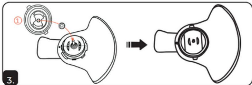
**3.** Após a instalação da tampa, coloque-a de volta. **Atenção!** O furo hexagonal da tampa está alinhado com a porca em formato hexagonal no eixo de saída.
