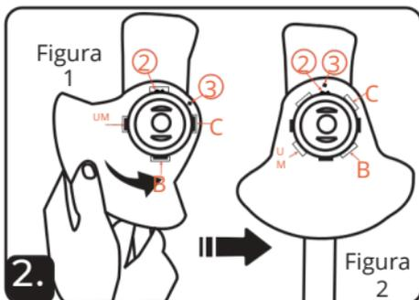
Posicione a proteção da lâmina exatamente como mostrado na Figura 1 e gire no sentido anti-horário para fazer 3 para bloquear com 2 como mostrado na figura 2.
